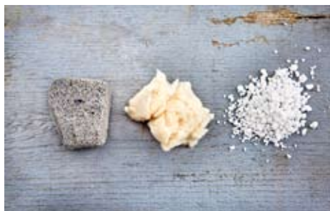
Byggmaterial. Lättklinker, cellulosafiber och perlit.
